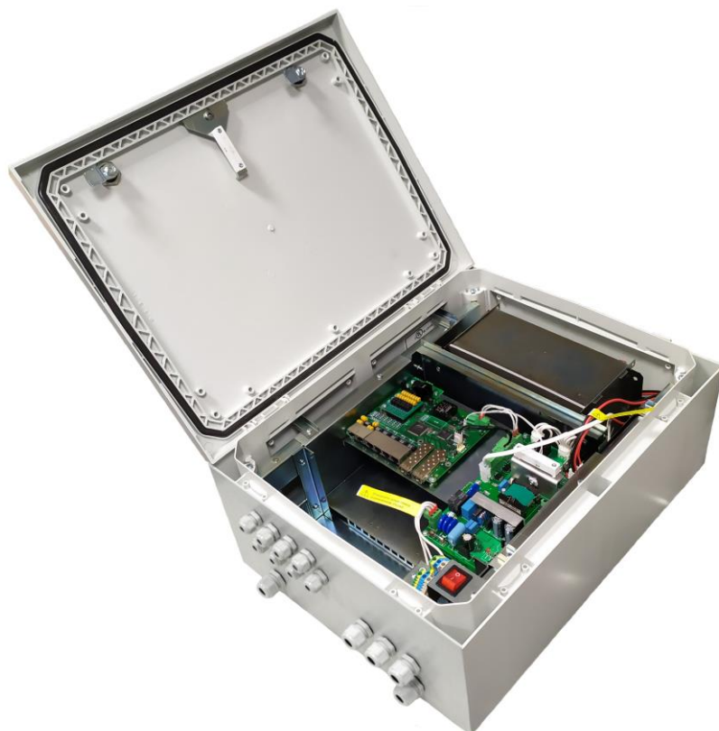
Рисунок 3.1.2 - PSW-2G6F+UPS-Box - вид внутри
