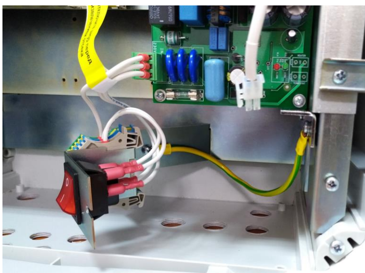
Рисунок 3.5.2 – Узел подключения питания освобожден от крепежа.
